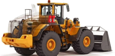
Sistem Pencegah Kebakaran Untuk Alat Berat
